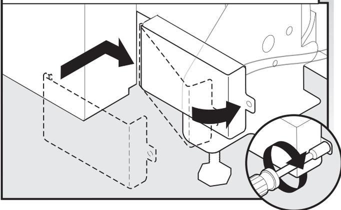
Placer les fils à l'intérieur du boîtier. Insérer les pattes du côté gauche du couvercle. Vérifier que les conducteurs sont bien engagés à l'intérieur du boîtier. Fermer le couvercle - veiller à ne pas coincer des conducteurs. Utiliser un tourne-écrou de 1/4" pour réinstaller la vis de fixation du couvercle.
